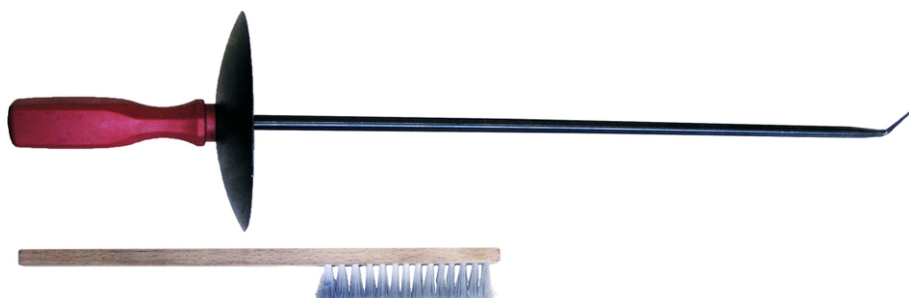
Beispiel: Spänehooken und Spänebürste
